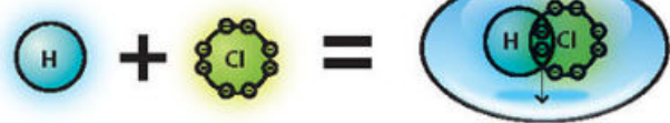
Fig. 2.52 Cuando se comparte un par de electrones entre hidrógeno y cloro para dar HCl, el cloro ejerce una mayor atracción sobre los electrones.
