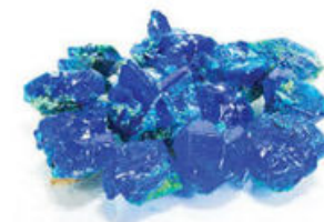
Fig. 1.54 Cristales de sulfato de cobre II (CuSO 4 ), obtenidos de una disolución acuosa por cristalización.
