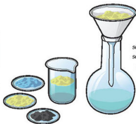
Fig. 1.53 La filtración sirve para separar una mezcla heterogénea de un sólido y un líquido. El papel filtro retiene el sólido y deja pasar el líquido.
