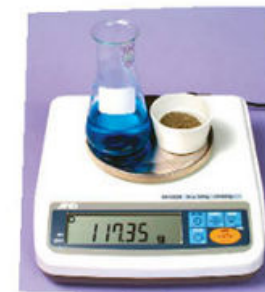
Fig. 1.47 Para expresar la concentración en masa de una disolución, es necesario medir la masa del soluto y la de la disolución.
