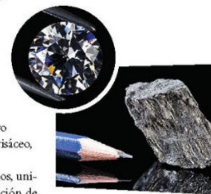
Fig. 2.59 A simple vista parecen materiales totalmente diferentes, y aunque en realidad por sus características lo son, grafito y diamante están formados por el mismo tipo de átomos, la diferencia está relacionada con la estructura cristalina.
