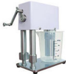
Fig. 1.35 Instrumento para medir la viscosidad del aceite automotriz.
