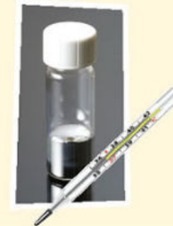
Fig. 2.66 El mercurio es un metal pesado muy tóxico que se usa en muchos procesos industriales y en la fabricación de instrumentos, como los termómetros.
