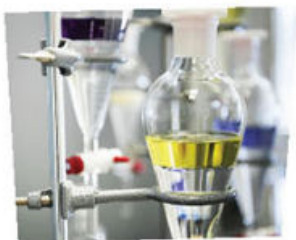
Fig. 1.52 Embudo de separación listo para usarse.
